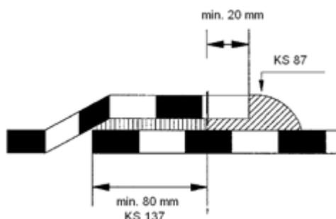
Fig. 4: – Raccord par recouvrement au moyen des colles KS137 + KS87
