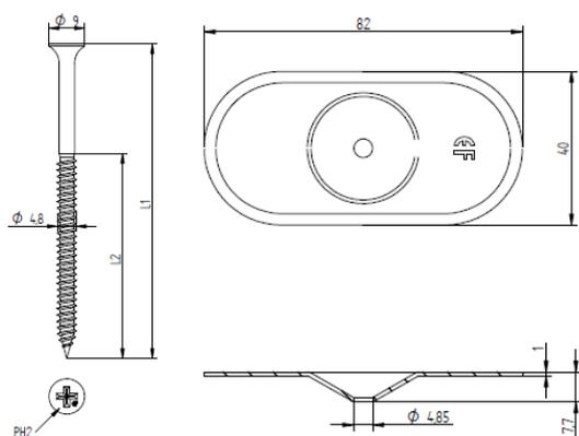
**Fig. 1:** – Vis VRF EUROFAST® EDS-S + plaquette VRF EUROFAST® DVP-EF-8040N
