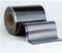
Le Tiplon flashing est une bande autoadhésive en caoutchouc déformable non vulcanisé qu'il convient d'appliquer sur un support parfaitement sec et prétraité au Primer Tiplon. La bande Tiplon flashing s'utilise pour parachever le travail aux endroits tels que les joints en T, la zone de transition entre une jonction verticale et une jonction horizontale ainsi que les raccords sur sorties cylindriques. Le côté adhésif de la bande est revêtu d'une feuille de protection transparente.
