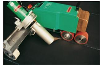
Les recouvrements longitudinaux sont réalisés avec un appareil automatique dans la mesure du possible, par exemple avec un Leister Varimat V2. Les joints périphériques et les pièces d'angle sont soudés à l'aide d'un appareil manuel, par exemple un Leister type Triac ST de 1600 W avec une buse plate de 40 mm de large.
