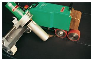
Dans la mesure du possible, il faut souder les recouvrements longitudinaux à la soudeuse automatique (par exemple une Leister Variant V2). Les raccords de rive et les pièces de coin sont exécutés au moyen d'une soudeuse manuelle, par exemple une Leister type Triac ST de 1600 W à bec plat de 40 mm de large. Pour les joints longitudinaux, on peut également utiliser une Leister type Electron de 3000 W avec bec de 75 mm de large.
