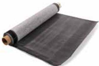
L'EPDM pre-tape de Mastersystems est doté d'une bande de joint appliquée sur le rouleau en usine. Ce joint unique offre de nombreux avantages en termes de qualité, de garanties et de rapidité de traitement. Grâce à notre pre-tape d'usine, la réalisation des joints est très efficace : apprêter un côté, enlever la feuille, enrouler et vous obtenez un résultat étanche.
