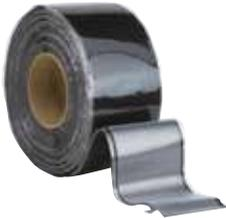
Masterflashing est une bande autoadhésive en caoutchouc déformable non vulcanisé qu'il convient d'appliquer sur un support parfaitement sec et prétraité au Masterstarter.
