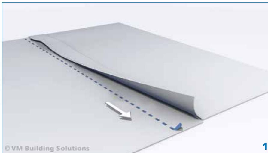
Parachèvement des joints longitudinaux au moyen de Masterbond
