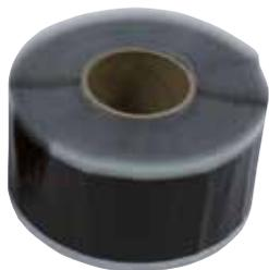
Masterbond est une bande de butyle qui adhère des deux côtés et doit être appliquée sur un support sec à 100 %, prétraité avec Masterstarter. Ce ruban se caractérise par la présence d'une feuille de protection résistante et transparente. La transparence de cette feuille permet de parfaitement positionner le ruban lors de son application. La résistance de la feuille évite le risque de déchirure et facilite la tâche de l'étancheur.
