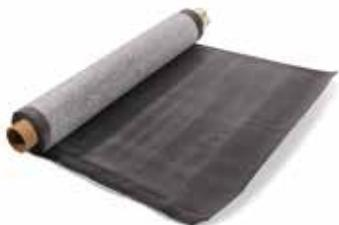
Le Mastersystems est un caoutchouc EPDM noir/gris sans structure en relief. En outre, l'EPDM a une sous-couche en polyester qui étale automatiquement la pression de vapeur. Le Mastersystems est un produit élastique, praticable et accessible, qui est résistant à l'ozone et aux rayons UV, et qui réclame un minimum d'entretien. De plus, le produit favorise la récupération et l'épuration des eaux pluviales.
