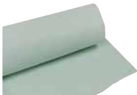
Géotextile est une couche de séparation de 300 grammes composée d'une nappe non tissée en polyester servant à protéger la membrane en EPDM; par exemple, dans le cadre d'applications lestées, avant la pose de la couche de lestage ou comme protection sur certains supports irréguliers.
