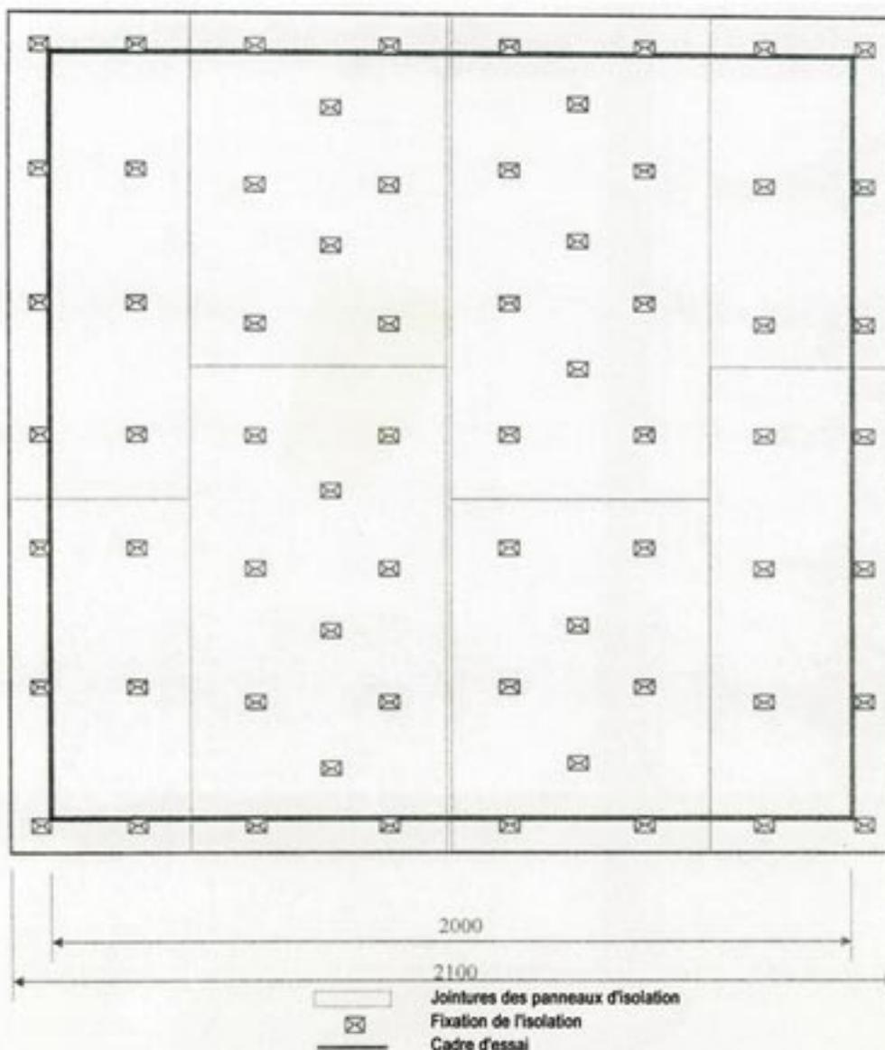
Les divers composants et leurs positions sont représentés schématiquement ci-dessus. Ce schéma a été rédigé par le laboratoire pendant le démontage de l'échantillon. Les dimensions sont données à titre informatif.
