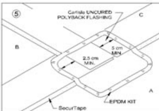
ENSUITE, VOUS TRATEZ TOUTS LES JOINTS EN T AVEC HP-250 PRIMER. QUAND LE PRIMER EST BIEN SEC, VOUS POSEZ UN MORCEAU DE FLASHING AUTOCOLLANT. MARQUEZ, EN ATTACHANT BEAUCOUP D'ATTENTION AUX ZONES À RISQUE PAR RAPPORT À L'HUMIDITÉ CAPILLAIRE, ET SCELLEZ AU MASTIC EPDM OU LAP SEALANT.
