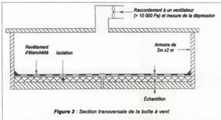
Figure 2 : Section transversale de la boîte à vent
