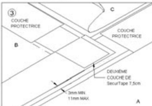
CRÉEZ D'ABORD UNE JONCTION DE LÉS ENTRE LES MEMBRANES QUI SE TROUVENT EN POSITION INFÉRIEURE, ICI INDIGUÉES PAR A ET B. PAR APRÈS, VOUS FAITES LA JONCTION DE LÉS AVEC LA MEMBRANE EN POSITION SUPÉRIEURE, INDIGUÉE ICI PAR C.
