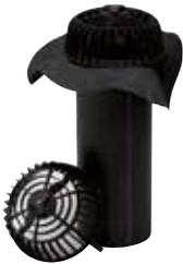
Après le placement du dispositif d'évacuation des eaux de pluie (sur la membrane Mastersystems EPDM), il convient de coller la platine au Mastic Master. Attention, la distance de la plaquette de fixation et le bord de la platine devrait être de minimum 5 cm. Pour obtenir une adhérence satisfaisante avant l'application du Mastic Master, il faut soumettre aussi bien la surface de pose que le dessous de la platine à un prétraitement au Master Polyback starter.
