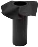
Pour répondre à tous les besoins d'évacuations des eaux de pluie, un dispositif de haute qualité alliant tuyau de descente en polyéthylène et platine souple en EPDM soudé en usine garantit une étanchéité totale. La partie de membrane en caoutchouc EPDM autour du passage du tuyau de descente se fixe au moyen de quatre plaquettes de répartition de la pression et d'une fixation adaptée au support concerné.
