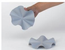
Les coins préfabriqués sont produits en Bande grise de finition Evalastic. Vous pouvez finir tous les coins inférieurs et extérieurs de 80°C jusqu'à 110°C au moyen de ces coins préfabriqués et vous pouvez facilement les souder à l'air chaud.
