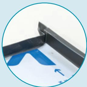
Relevez les têtes des bacs à 90° sur une hauteur de 15 mm et réalisez des coins de mouchoir aux angles.
