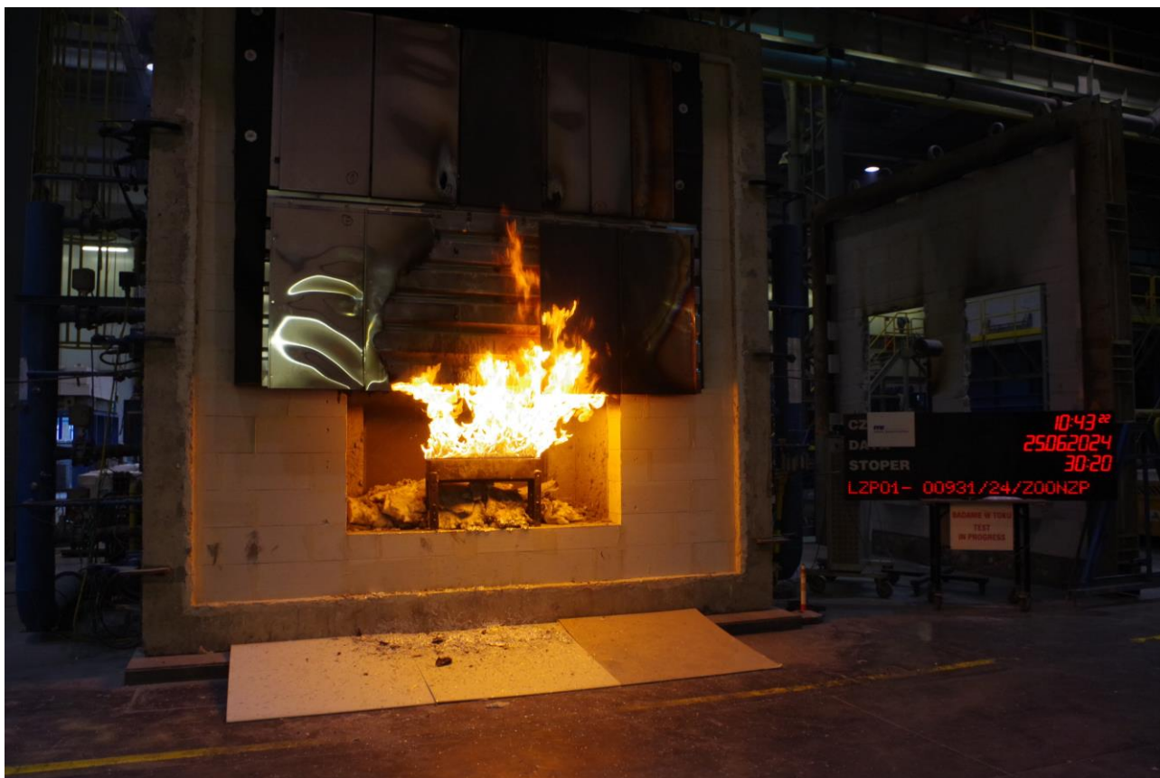
Rys. 20. Widok próbki podczas badania – 31 minuta
