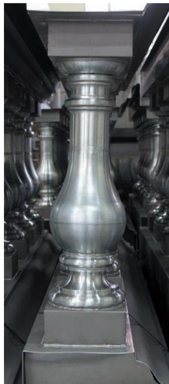
Die Installateure schauten sich die Zinkteile und den Montageplan vorab in der Werkstatt an und übten den Zusammenbau. Allen diesen Maßnahmen ist das herausragende Endergebnis zu verdanken.
