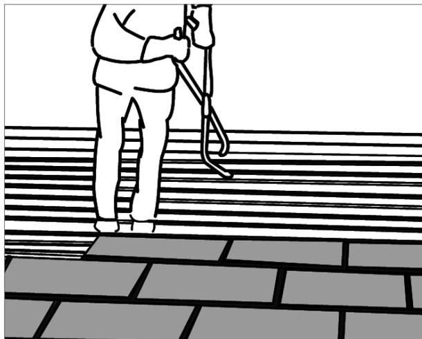
Pose des panneaux sur bac acier le long côté parallèle aux nervures en serrant les joints
