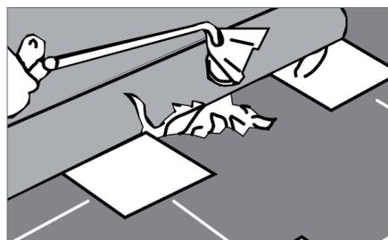
Pose de la membrane bitumineuse par soudage
