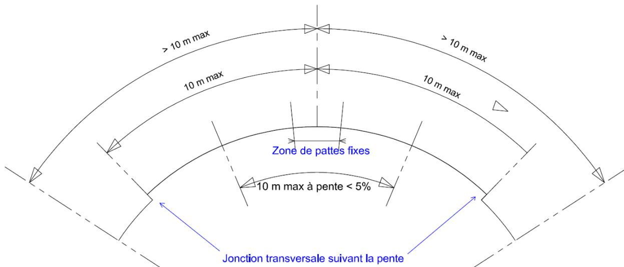
Figure 12 - Dispositions spécifiques aux toitures simple courbure
