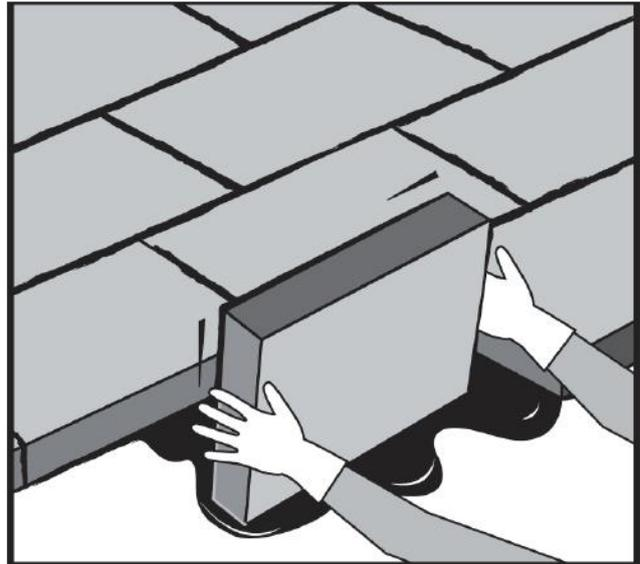
**Figure 9b – Pose de la plaque isolante, Les deux bords de la plaque sont trempés dans l'EAC**
