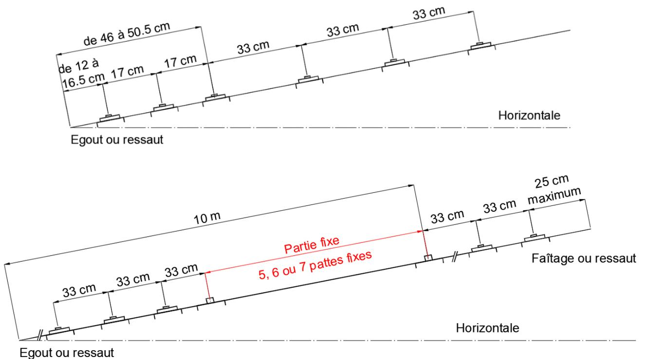
**Figure 7bis - Entraxe maximum des pattes coulissantes (cm) joint-début en partie courante**
