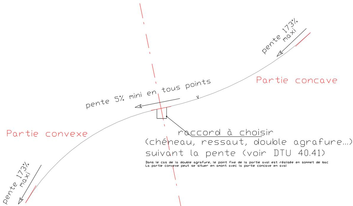
Figure 13 – Rupture sur couvertures de type concave-convexe (cf. § 2.4.6.1)
