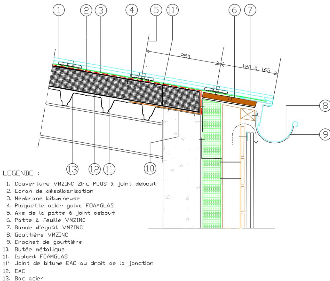
Nota : selon la configuration du bâtiment, il convient d'étudier le raccord avec la façade pour limiter le pont thermique de liaison.
