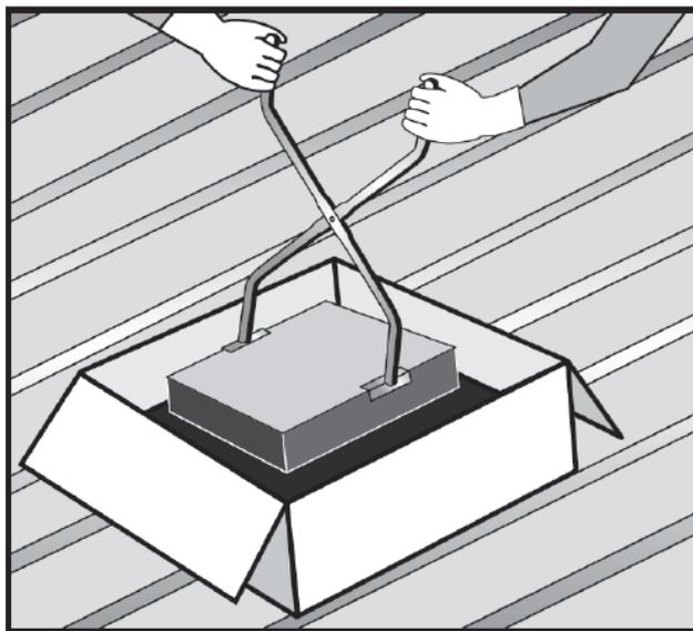
**Figure 8b – Consommation d'EAC pour le collage : 1,2 kg/m<sup>2</sup> au minimum**
