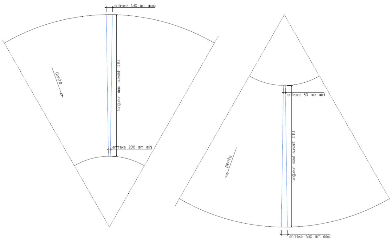
**Figure 19 – Dimensions limites des feuilles zinc pour toitures double courbure**
