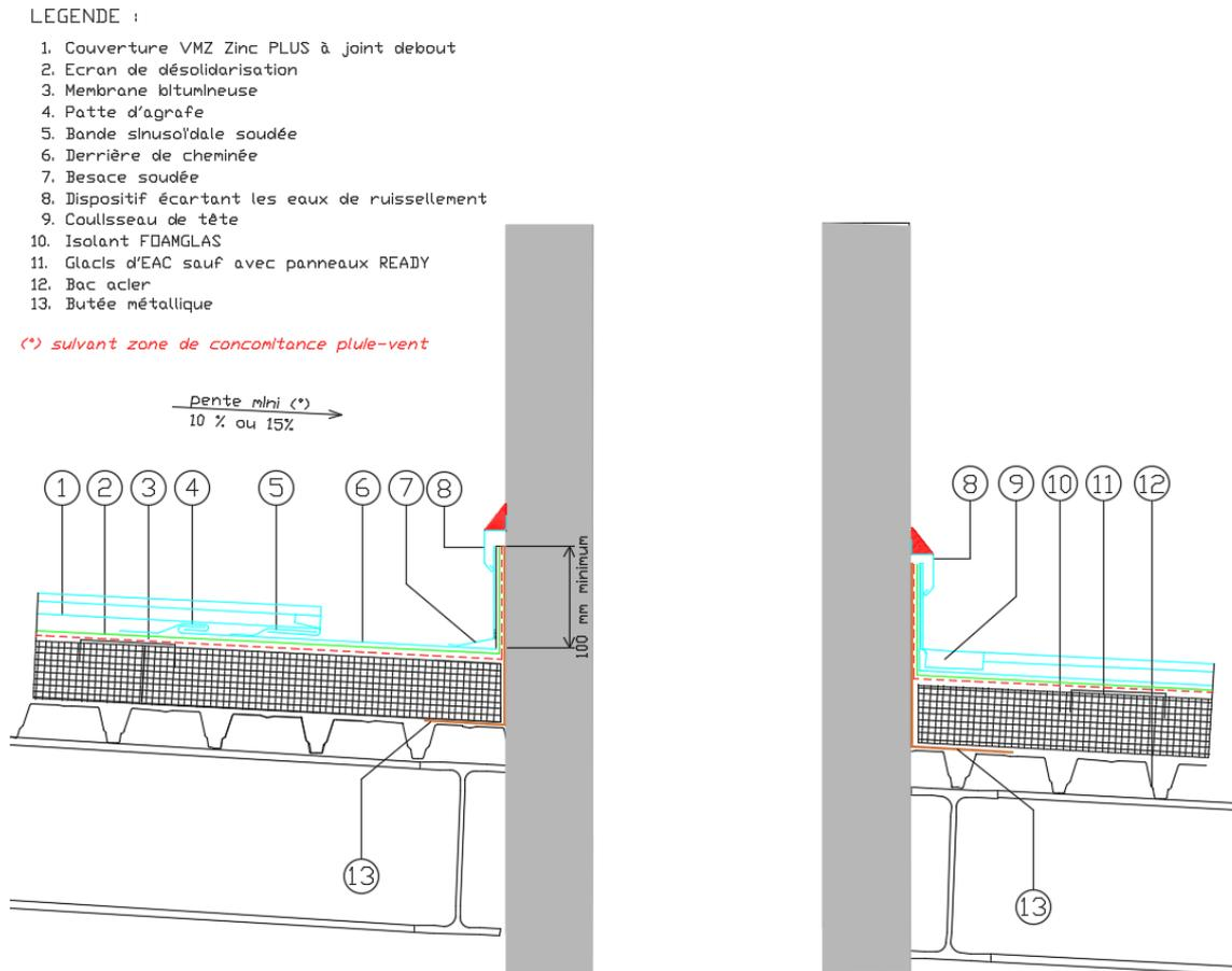
*Nota : la largeur maximale perpendiculaire à la pente doit être conforme au DTU 40.41*
