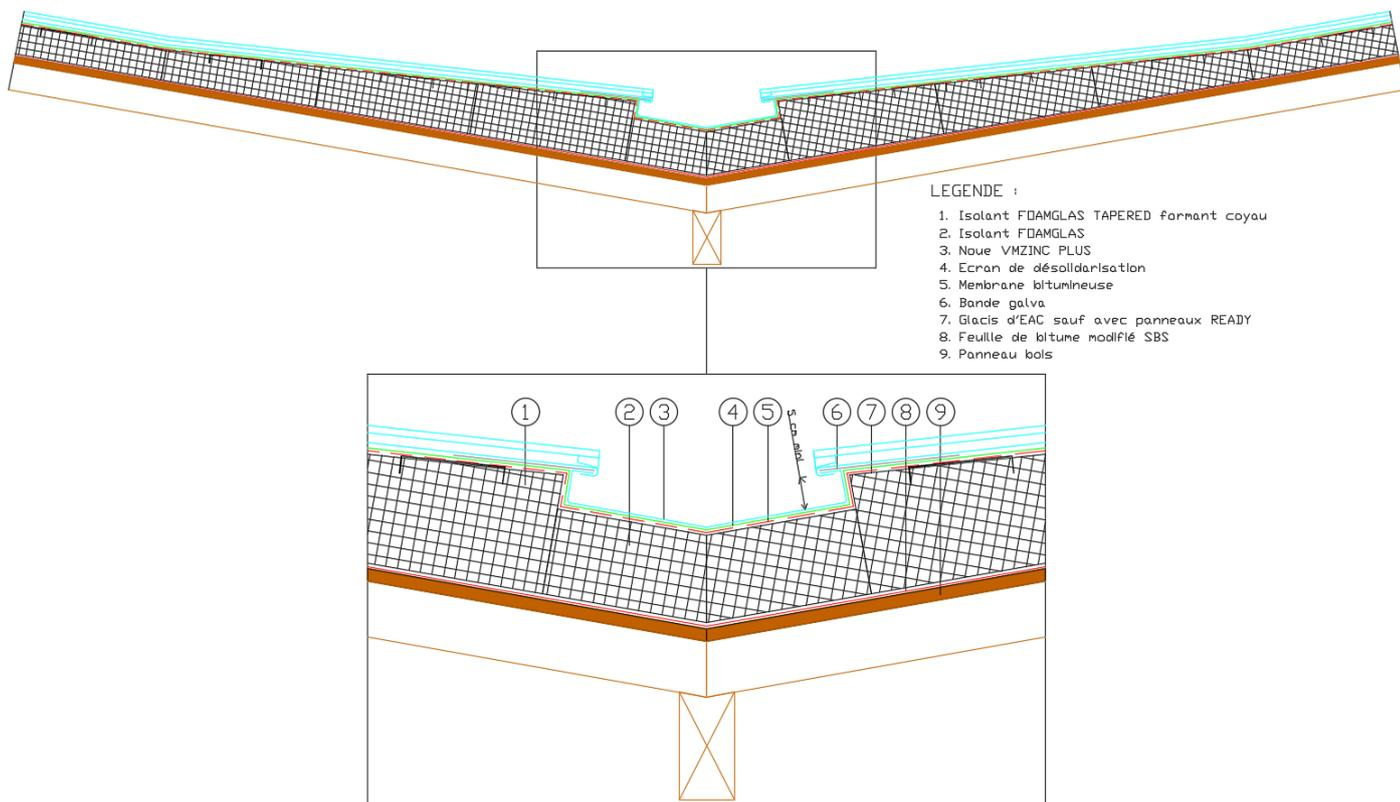
**Figure 28 – Noue encaissée**
