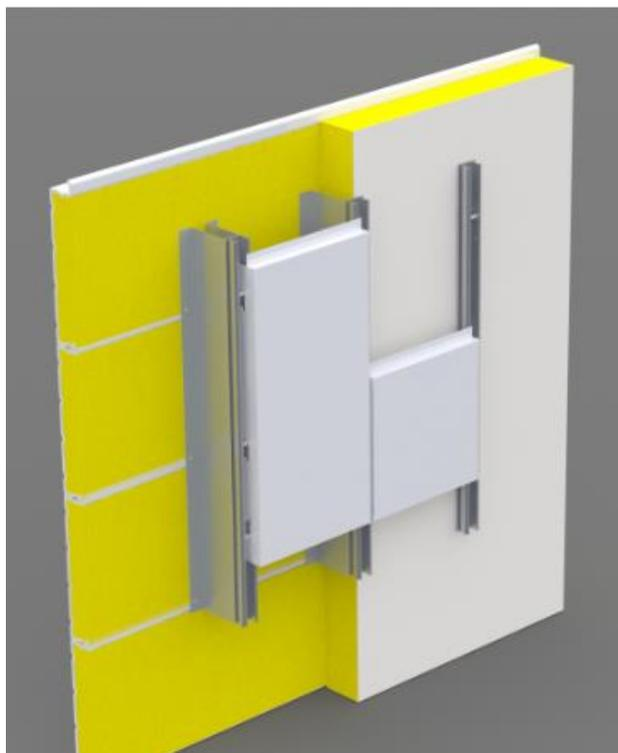
Ecarteurs réalisés avec des profils Z
