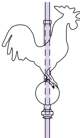
Montage sur fourreau traversant avec un galet.
