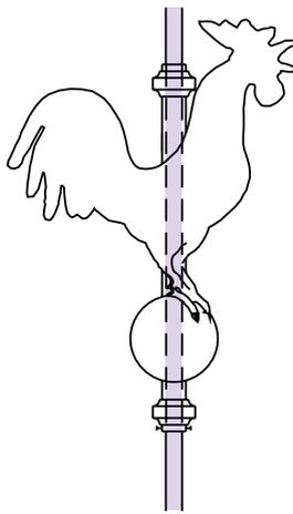
Montage sur fourreau traversant avec deux galets.
