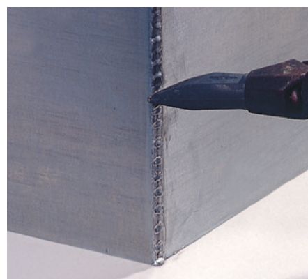
Soudo-brasage à gradins
