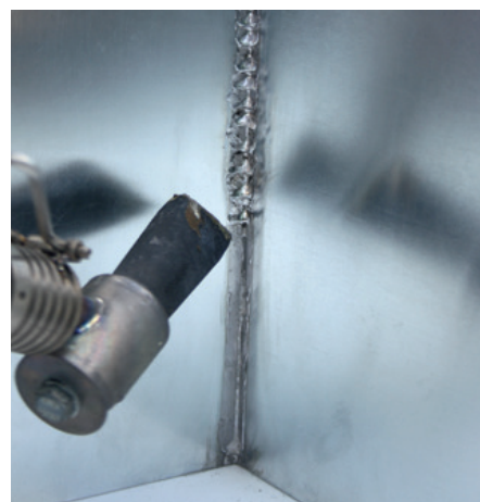
Soudo-brasage à gradins
