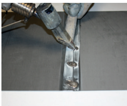
Pointage des éléments à souder
