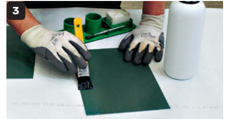
3 Décapage de la couche PIGMENTO® avec du décapant et laissez le produit agir pendant quelques minutes.
