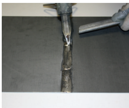
Réalisation du soudo-brasage
