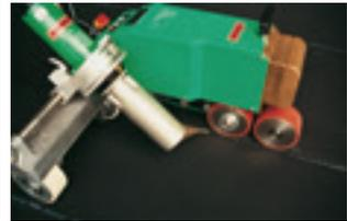
Dans la mesure du possible, il faut souder les recouvrements longitudinaux à la soudeuse automatique (par exemple une Leister Variant V2). Les raccords de rive et les pièces de coin sont exécutés au moyen d'une soudeuse manuelle, par exemple une Leister type Triac ST de 1600 W à bec plat de 40 mm de large. Pour les joints longitudinaux, on peut également utiliser une Leister type Electron de 3000 W avec bec de 75 mm de large.
