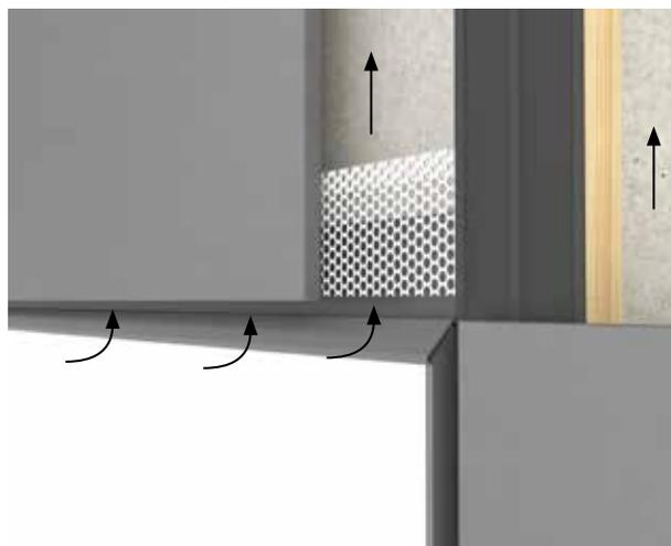
Une ouverture de ventilation horizontale doit également être prévue au-dessus des portes et fenêtres. Cette ouverture doit être d'au moins 10 mm de large. Si des profilés perforés en acier, en aluminium ou en plastique sont utilisés, l'ouverture de ventilation doit être d'au moins  $100 \text{ cm}^2$  par mètre. L'ouverture au bas de la façade servira aussi à évacuer l'humidité qui s'est infiltrée dans la façade
