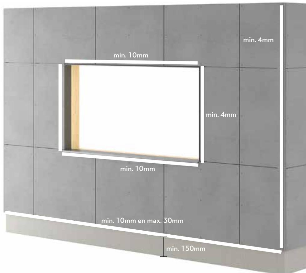
Respectez les distances mentionnées dans ce manuel. Le panneau de façade doit s'arrêter à une distance de 10 à 30 mm de l'extrémité de l'ossature. Pour les ouvrages en porte-à-faux et similaires, le panneau peut dépasser de max. 100 mm.
