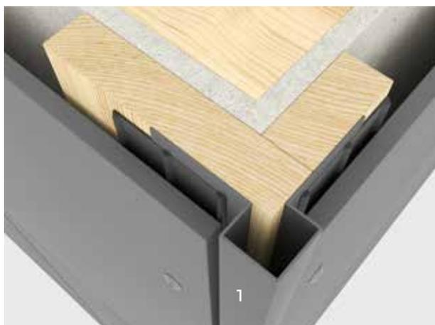
Le Petit Profilé d'angle extérieur Cembrit est utilisé pour les angles extérieurs de 90°. Le profilé est fixé à l'aide de rivets dans des trous préforés de Ø4 mm présentant un entraxe de 400-500 mm. Les éléments de fixation des panneaux de façade maintiennent le profilé en place. Prévoyez une ouverture d'au moins 4 mm entre le bord du panneau et le profilé.
