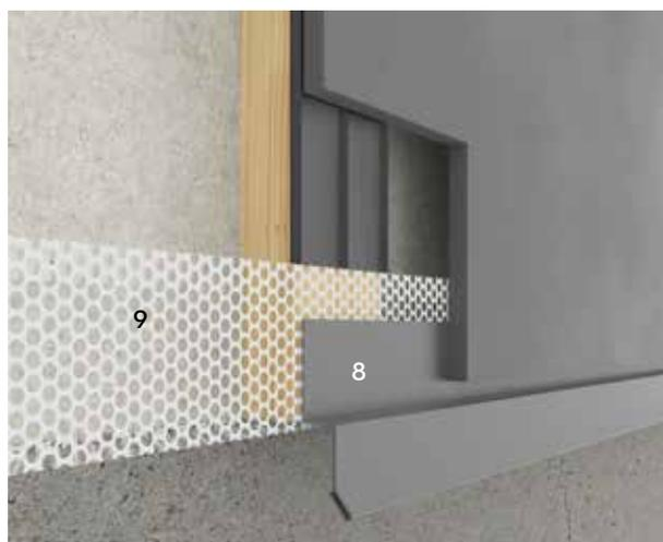
Le Petit Larmier Cembrit est utilisé pour évacuer l'eau de la structure porteuse ou lorsqu'une finition soignée s'impose. Le profilé peut être utilisé en combinaison avec un Profilé de Ventilation Cembrit afin d'éviter que des insectes ou de la vermine viennent se nicher derrière les panneaux de façade. Prévoyez une ouverture d'au moins 4 mm entre le bord du panneau et le profilé.
