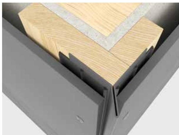
Des Profilés d'angle extérieur en pointe Cembrit peuvent également être utilisés pour les angles extérieurs de 90°. Comme les Petits Profilés d'angle extérieur Cembrit, ils sont fixés à l'aide de rivets. La distance entre le bord intérieur du panneau de façade et le profilé doit être d'au moins 2 mm.
