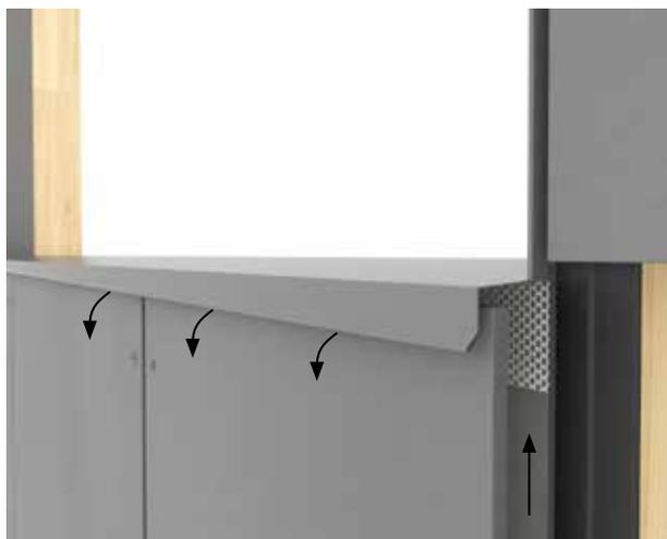
Sous les appuis de fenêtres ou autres ouvertures dans la façade avec seuil, une ouverture de ventilation horizontale d'au moins  $100 \text{ cm}^2$  par mètre sera prévue. Cette ouverture de ventilation se trouvera principalement entre le bord supérieur des panneaux de façade et le bord inférieur du seuil. Il est conseillé de veiller à ce que le seuil dépasse d'au moins 30 mm, de façon à ce que l'eau s'écoulant du seuil ne pénètre pas dans l'ossature.
